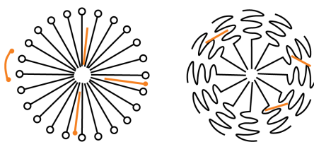
Figure 4.7: Loci de solubilisation de molécules aux polarités différentes (en orange) dans des micelles de surfactant ionique à gauche et non-ionique à droite (Adapté de Rosen et Kunjappu, 2012).
