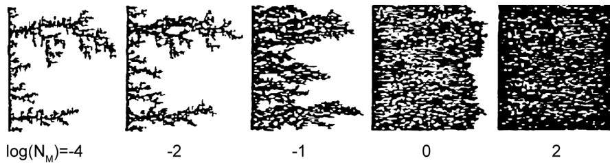
Figure 3.14: Simulation de l'écoulement de deux fluides pour des N_M différents et N_{Ca} = 1 (Adapté de Lenormand et al. , 1988).
