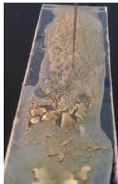
Figure 39. Dépôt d'une goutte de la solution NaOCl sur de l'argile séchée sur un support en polystyrène.
