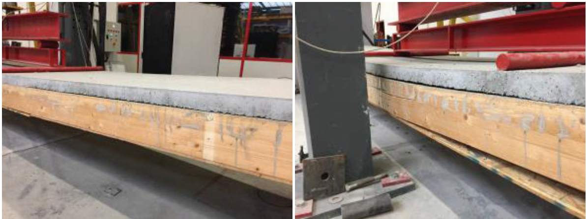
Figure X-13 : Décollement du béton, à gauche sur les extrémités, à droite lors de la rupture finale en partie centrale
