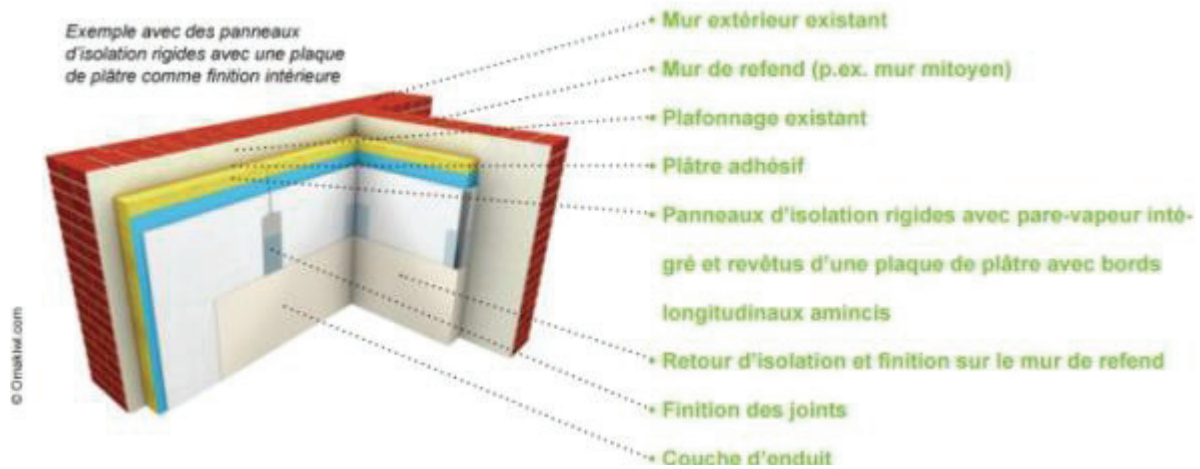
Figure II-31 : Mur isolé par l'intérieur
