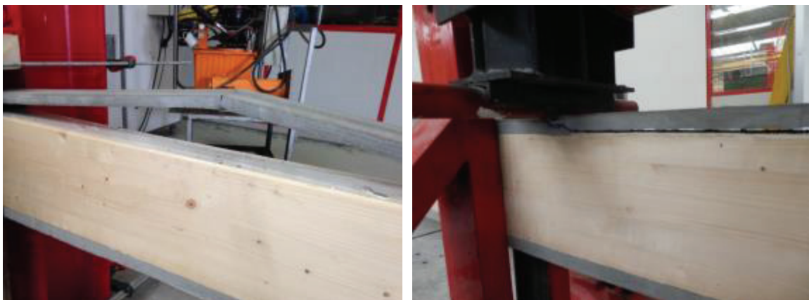
Figure V-16 : Rupture par décollement du béton, poutres D et C_2 à gauche et à droite respectivement
