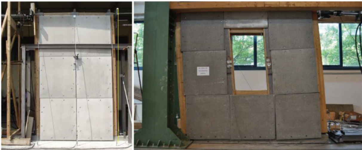
Figure II-34 : Mur B et mur C après essais
