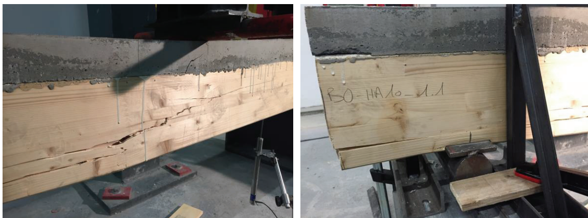
Figure V-29 : Rupture par cisaillement de la poutre 1.1 (gauche) et écrasement local sur appui avec délamination (droite)
