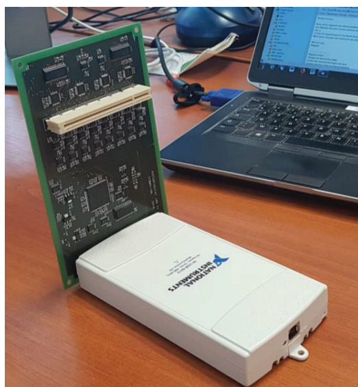
Figure 109. Photographie de la nouvelle version du lecteur de plaques de criblage électrochimique conçu au sein du laboratoire « Laboratoire d'Electronique, Nanotechnologie et Capteurs ».
