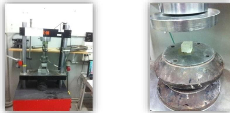
**Figure II 8. Détermination de la résistance à la compression (traitement de données obtenues avec calcul de la moyenne)**
