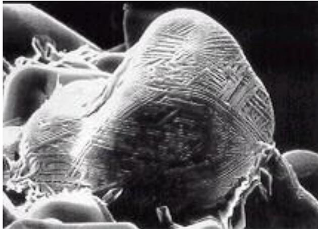
**Figure I 11. Cristaux de la Bélite sous microscope électronique à balayage**
