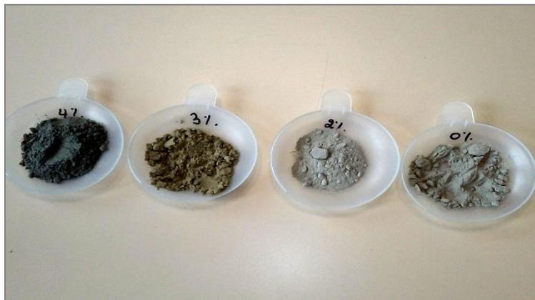
**Figure III 10.** *Les différentes couleurs des ciments synthétisés à  $1300^\circ\text{C}$  avec 0, 2, 3 et 4% de sulfate de zinc (de droite à gauche)*
