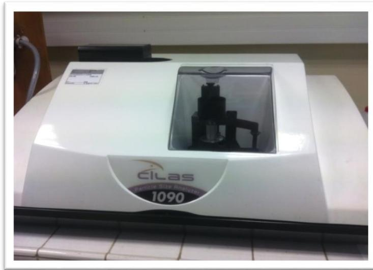
**Figure II 5. Granulomètre Laser CILAS 1090 (LMDC)**
