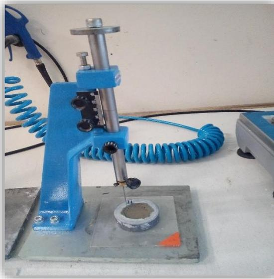
**Figure II 6. Appareillage VICAT de détermination du temps de prise (test mini-prise)**
