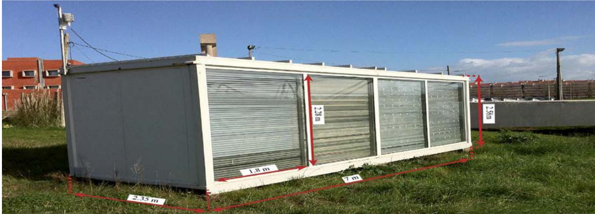
Figure 1.10 Comparaison entre deux compartiments l'un intégrant du MCP et l'autre sans MCP
