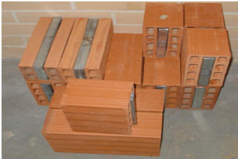
*Figure 1.8 Inclusion du MCP encapsulé dans les briques*
