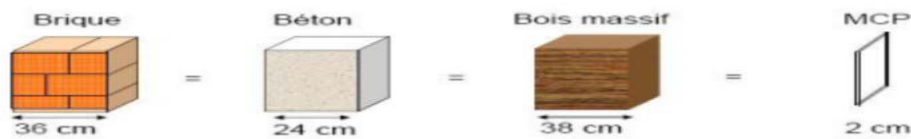
Figure 1.5 Schéma comparatif des inerties thermiques en fonction de l'épaisseur et de la nature du matériau
