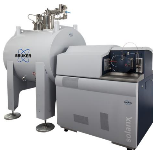
Figure IV-4 : Spectromètre de masse Bruker Solarix XR équipé d'une source ICR et d'un aimant supraconducteur de 9.4 Tesla
