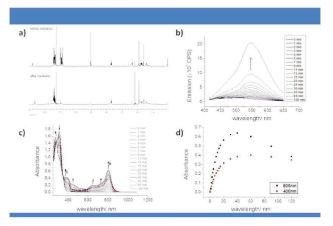
**Figure 3.** Phénomène d'auto-assemblage induit par l'irradiation lumineuse pour le compose **TAMT** mis en évidence par a) RMN <sup>1</sup>H dans le chloroforme deutérié ([**TAMT**] ~ 1 mM), b) spectrocopie de fluorescence (0.1 mM dans CDCl<sub>3</sub>, excitation à 400 nm) et c-d) spectroscopie UV-Vis-NIR (0.1 mM dans CDCl<sub>3</sub>). Le graphique reporté en d) indique l'évolution de l'absorbance à 805 et 400 nm pour des temps d'irradiation croissant.
