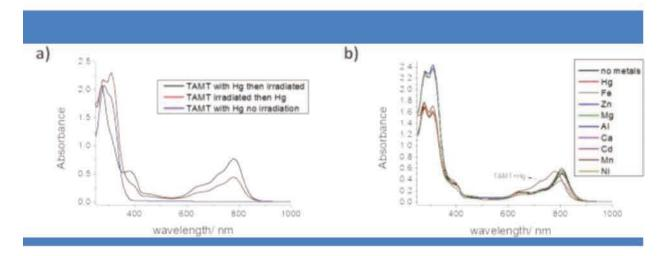
**Figure 5.** a) Spectres d'absorbance UV-vis-NIR obtenus pour le composé **TAMT** dans diverses conditions (avec/sans HgCl<sub>2</sub> et/ou avec/sans irradiation lumineuse, 0.1 mM dans le chloroforme); b) Spectres d'absorbance UV-vis-NIR obtenus pour une solution irradiée du composé **TAMT** (0.1 mM dans le chloroforme, irradiation durant 20 min) après addition de 0.8 équivalents de différents ions métalliques.
