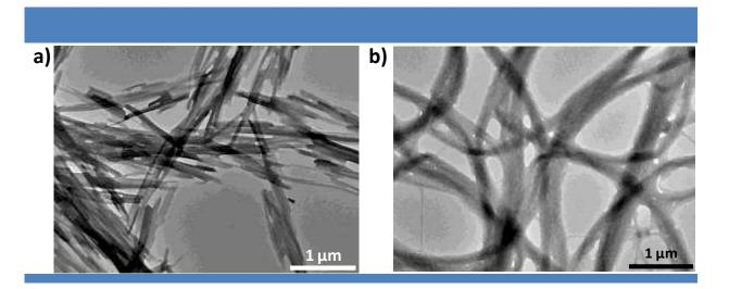
**Figure 4.** Images TEM de l'auto-assemblage des molécules a) **TAMT** en présence de mélamine dans le toluène et b) **TAMG** en présence de  $KPF_6$  dans le toluène.
