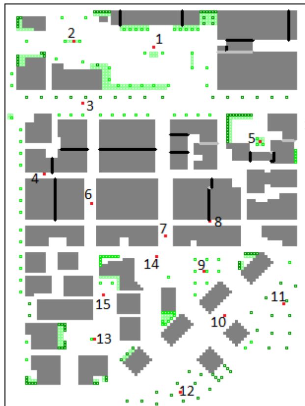
Figure 4.5: Modèle 2D du quartier végétalisé créée à l'aide d'ENVI-met montrant les récepteurs installés (points rouges) par rapport aux espèces végétalisées.
