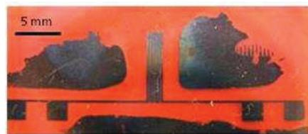
*Figure V-19 : Thermorésistance ( $R_3$ ) fabriquée par métallisation active (durée ~ 20 min) dans un bain électroless à base d'hydrazine sur un substrat polyimide.*
