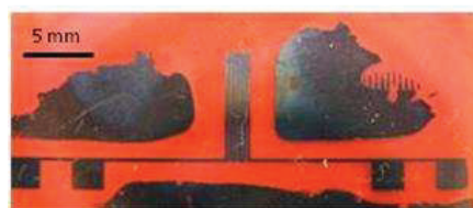
Figure V-19 : Thermorésistance ( R_3 ) fabriquée par métallisation active (durée ~ 20 min) dans un bain électroless à base d'hydrazine sur un substrat polyimide.
