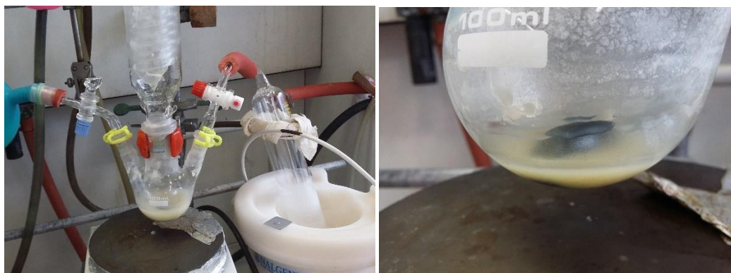
Figure 20 : Système d'évaporation de l'ammoniac grâce à une pompe et un piège d'azote liquide (à gauche). Enolate lithié et sels de réaction après évaporation totale de l'ammoniac (à droite).
