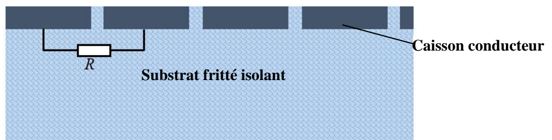
Figure IV-13 : Structure du substrat fritté intégré
