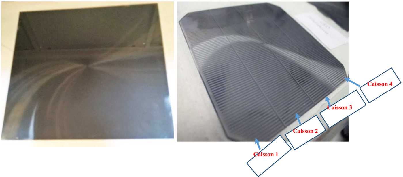
Figure IV-16 : Photographie d'un substrat de silicium fritté ( 156 \times 156 \text{ mm}^2 ) avant intégration des caissons (gauche) ; Après intégration des caissons et nettoyage du substrat intégré (droite).
