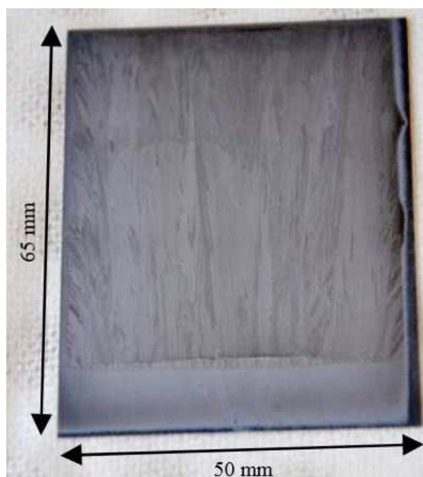
Figure II-10 : Photographie après recristallisation de la couche silicium P + sur le substrat fritté – réalisation de la couche de germination avant la croissance épitaxiale de la couche active [20].
