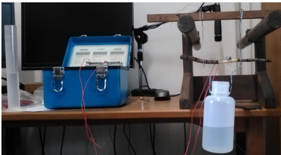
Figure 24. Protocole alternatif de mesure de module. La force appliquée est calculée selon le volume d'eau rajouté et de la gravité. Des morceaux de tuyau métallique évitent la détérioration de l'échantillon aux appuis.
