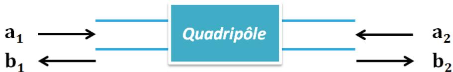
Figure 1.2. Ondes incidentes et ondes réfléchies appliquées à un quadripôle
