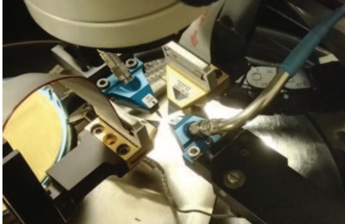
Figure 0.4. Photo des pointes de mesure RF (en bleu) et des pointes de polarisation DC (en doré) placées orthogonalement
