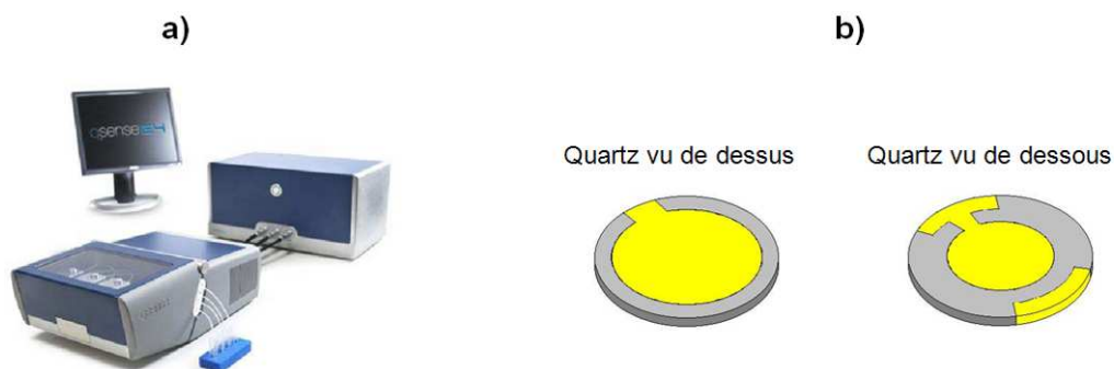
Figure 29 : a) Photographie d'une microbalance à quartz (Q-SENSE E4) ; b) schéma représentant un quartz vu de dessus et de dessous, les électrodes sont représentées en jaune et le quartz en gris. (Images adaptées du site internet http://www.q-sense.com ).
