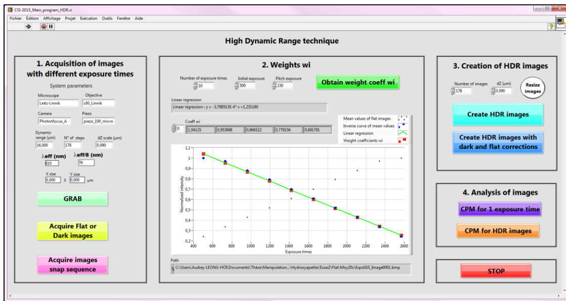
Figure 3-21. Programme Labview pour générer des images HDR.
