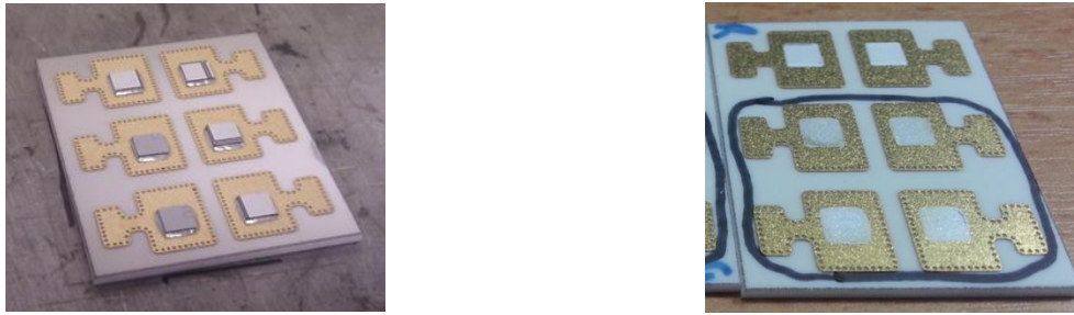
Figure 136: Assemblage avant shear test à gauche et après shear test à droite
