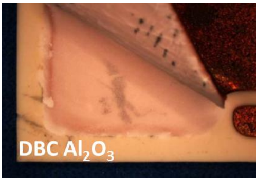
Figure 31: Cassure conchoïdale de l'alumine [18]
