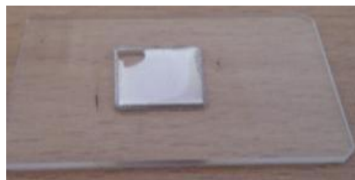
Figure 208: joint d'argent fritté sur substrat en verre à 285°C pendant 30 min sous 2 MPa. Le morceau de silicium (puce factice) ayant servi à appliquer la pression a été retiré afin de permettre le contact pointes de mesure/joint d'argent.
