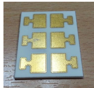
Figure 47: Substrat de puissance nickelé doré (flash Au)
