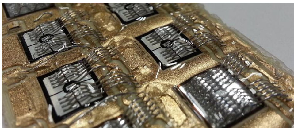
Figure 43: Composants brasés et câblés sur substrat avec encapsulant (gel silicone)
