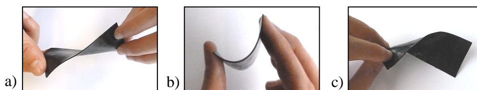
Figure II- 14. Photographies illustrant la flexibilité des matériaux synthétisés pour la série S5- a) S5 120/21 ; b) S5 60/18 ; c) S5 60/21 .
