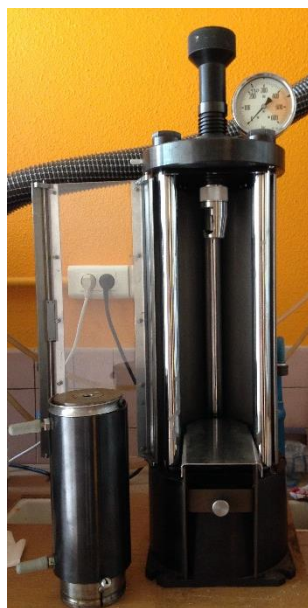
Figure 14: dispositif de haute pression du LCOS
