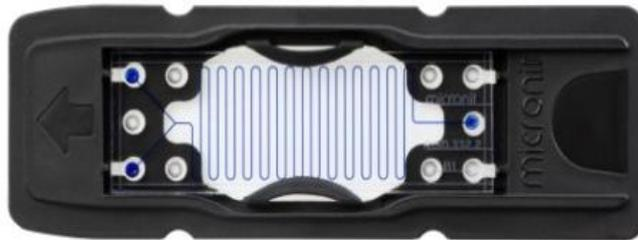
Figure 49: Dispositif microfluidique en verre ou en polymère développé par l'entreprise Micronit [11].
