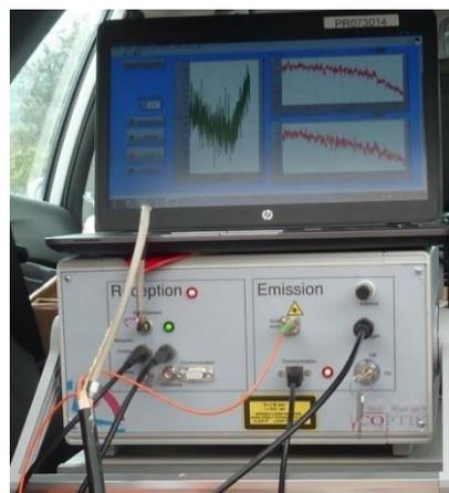
**Figure 15. Variation de l'amplitude du signal en sortie de détecteur IR pour différentes concentrations de CO<sub>2</sub> mesurées dans un puits de 100 mètres de profondeur (à gauche) et système de pilotage en surface dans sa configuration 2016 (à droite).**
