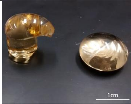
Figure 51: Photographie d'un verre de calcio-aluminat de composition 52\text{CaO}-36\text{Al}_2\text{O}_3-6\text{Na}_2\text{O}-6\text{BaO} (%mol.) synthétisé au cours des essais exploratoires.
