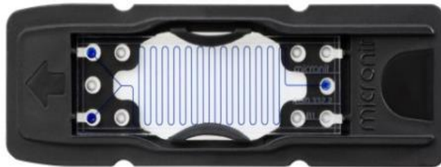
Figure 49: Dispositif microfluidique en verre ou en polymère développé par l'entreprise Micronit [11].
