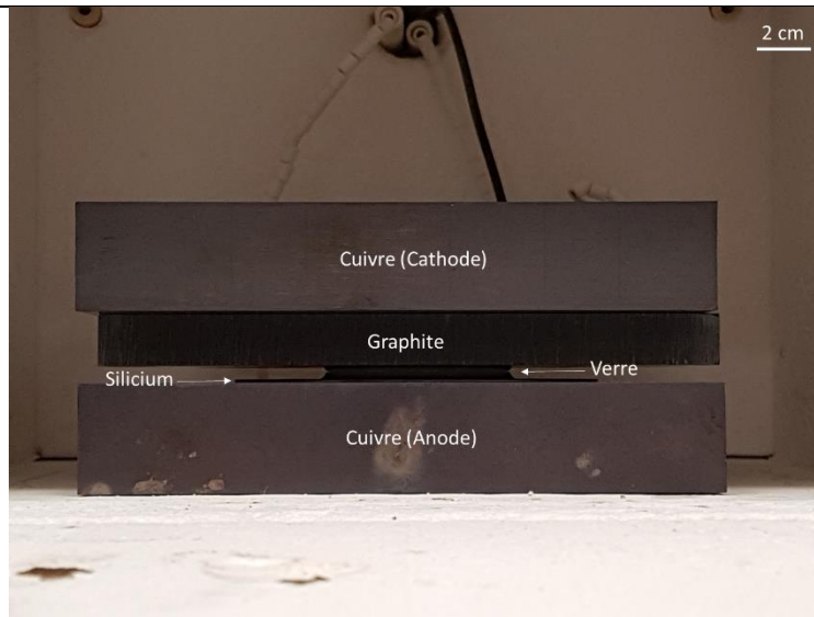
Figure 77. Photographie de la configuration de collage anodique introduit dans le four.
