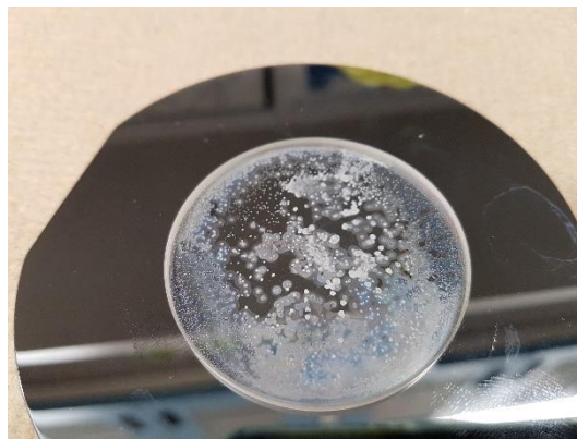
Figure 79. Test de collage non réussi du Pyrex effectué à 400 °C.
