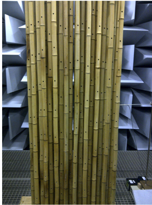
FIGURE 1.5 – Photographie du cristal testé, composé de 5 lignes de 9 bambous.
