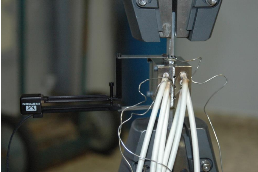
Fig. III.6 – Photo du montage de mesure de module de Young à chaud
