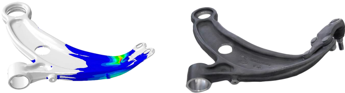
Fig. V.2 – Simulation du flambage d'un bras de suspension corrélée avec la réalité
