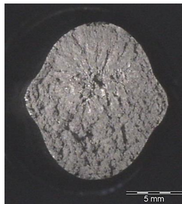
Fig. V.7 – Faciès de rupture d’une éprouvette de coulée avec amorce sur une retassure de cœur
