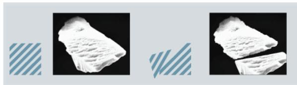
Figure 117 : Mode de fracture des diamants monocristallins ([www.vanmoppes.ch](http://www.vanmoppes.ch)).
