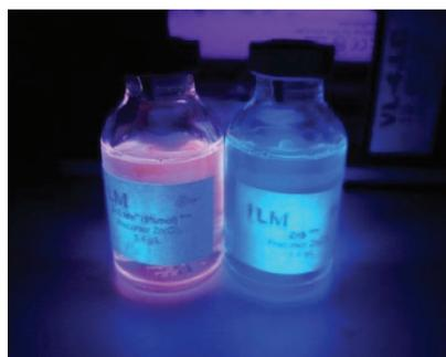
Figure 43 : NPs de ZnS 8,6 nm dopées et non dopées observées sous lampe UV( $\lambda_{exc}=323nm$ ).
