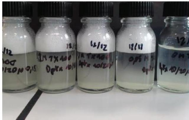
Figure 133 : Sédimentation des particules de diamants MC 10/20 $\mu\text{m}$  1 minute après agitation avec une concentration décroissante en TX100 de gauche à droite.
