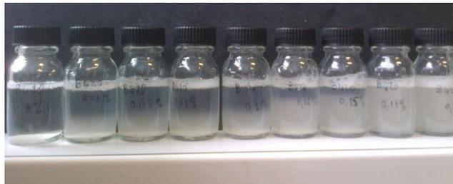
Figure 134 : Effet du Byk-D420 sur la stabilité de suspensions aqueuses de diamants MC 10/20 $\mu\text{m}$  à 0.1%wt. Concentration en BykD420 croissante de gauche à droite.
