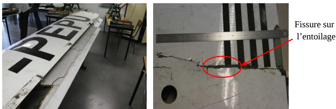
Figure 3.1 Etat de l'aile accidentée (aile A)
