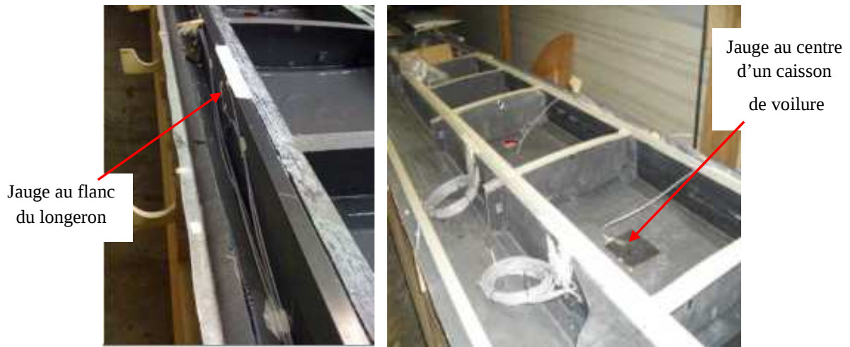
Figure 3.6 : Collage des jauges avant assemblage de la voilure
