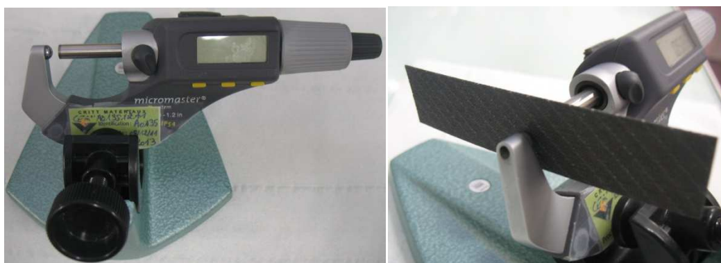
Fig. 3.2. Mesure des épaisseurs avec un micromètre à embout sphérique
