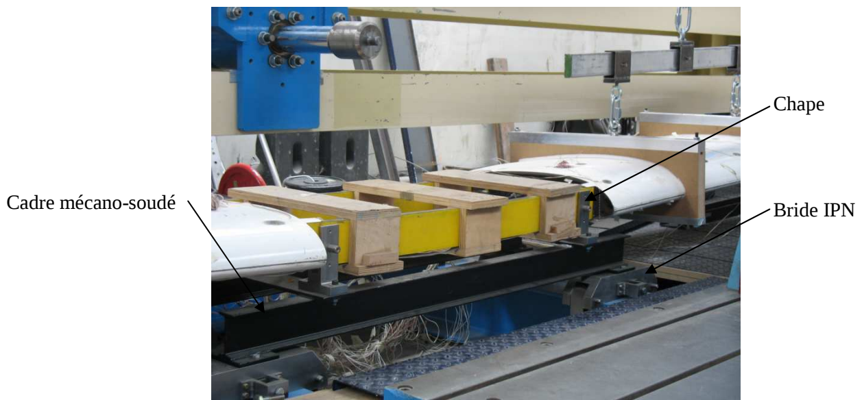
Figure 3.35 : Fixation de l'aile (endommagée) sur le banc d'essai
