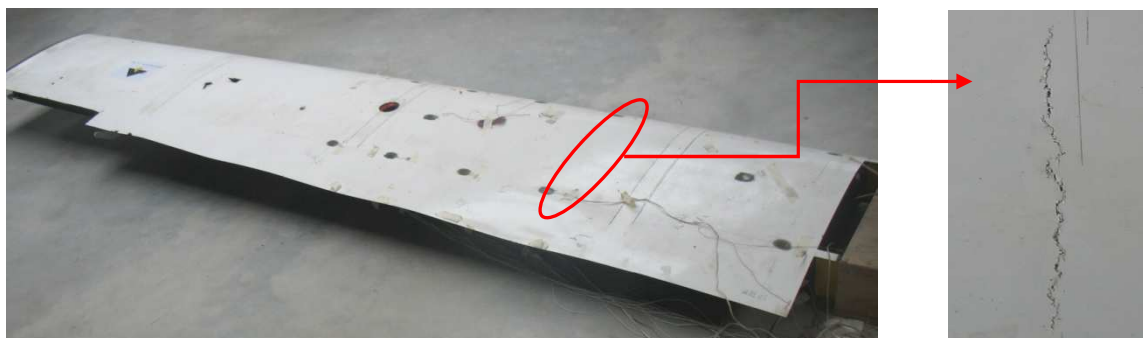
Figure 3.2 Etat de l'aile endommagée (aile B)
