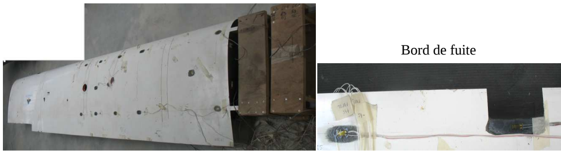
Figure 3.7 : A gauche - aile endommagée après instrumentation, à droite – jauge collée directement sur la semelle pour comparaison
