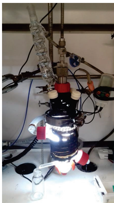
Figure III.16 Réacteur de photopolymérisation en émulsion utilisé par Le Quéméner avec le spectre d'émission d'une LED composant le ruban de LEDs
