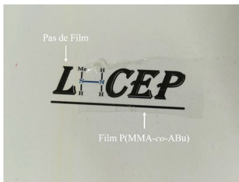
Figure III.38 Photographie d'un film obtenu après séchage d'un latex de P(MMA-co-ABu) synthétisé par photopolymérisation en émulsion d'un mélange MMA/ABu (40/60) amorcée par le système d'amorçage disulfure seul
