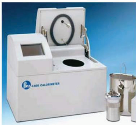
Figure V. 1 Calorimètre de combustion Parr 6200 (issu de la référence [2])
