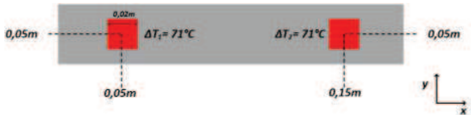
Figure 27: Vue du dessus de la semelle d'un dissipateur à ailettes, lorsque deux sources sont positionnées à sa surface. L'écart de température entre la source de chaleur et l'ambient est le même pour les deux sources puisque le système est symétrique.
