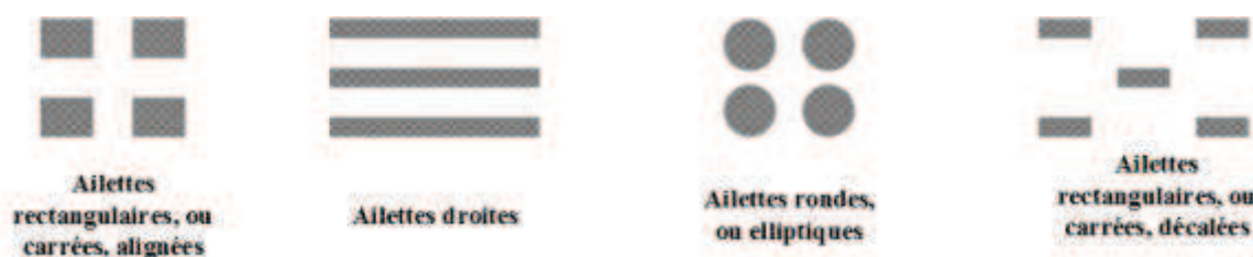
Figure 8 : Différentes formes d'ailettes classiques existant [25] . La liste présentée sur cette figure n'est pas exhaustive.
