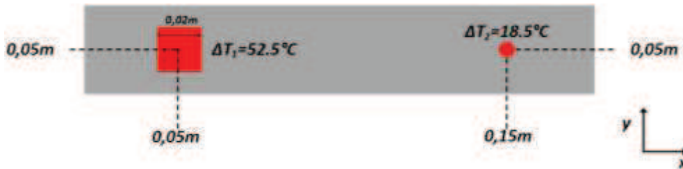
Figure 28: Vue du dessus de la semelle d'un dissipateur à ailettes, lorsque'une source est positionnée à gauche à sa surface.
