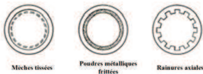
Figure 10: Différents types de réseaux capillaires possibles au sein d'un caloduc [13]
