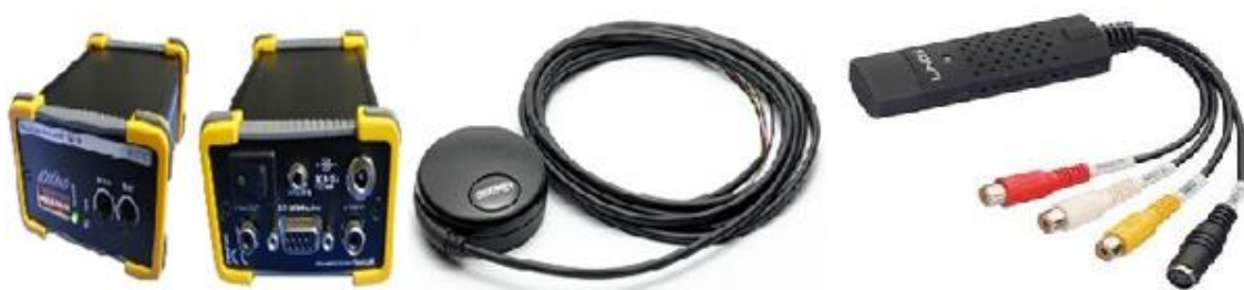
Figure III.7 : Le système time-inserter TIM10 (à gauche) et le système GPS (au milieu) pour horodater les images. Vidéo Grabber USB (à droite) : Carte d'acquisition sert à convertir la vidéo analogique en vidéo numérique et à la compresser avant de la traiter dans l'ordinateur.
