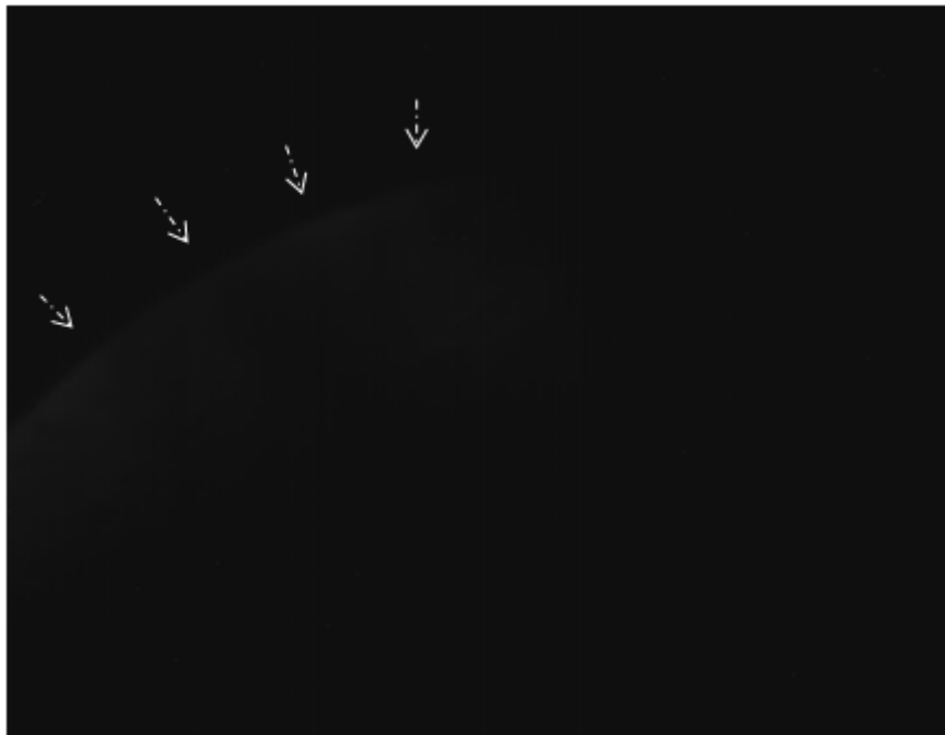
Figure IV.6 : La partie sombre du disque lunaire sur un champ de vision de 17*14arcmin, acquise par le C14. Le limbe est faiblement visible dans à gauche de l'image (contraste modifiée).
