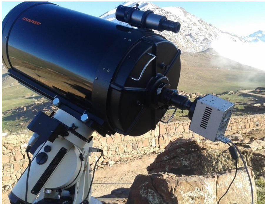
Figure IV.4 : Télescope C14 et Caméra XEVA-utilisée dans les observations infrarouges.
