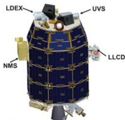
Figure II.9 : l'orbiteur LADEE "Masse: 383 kg; Dimensions: 2.37×1.85 m; Vitesse maximale: 5 760 km/h; Hauteur de l'orbite : 50 km; Vitesse en orbite : 1,6 km/s" (crédit-NASA).
