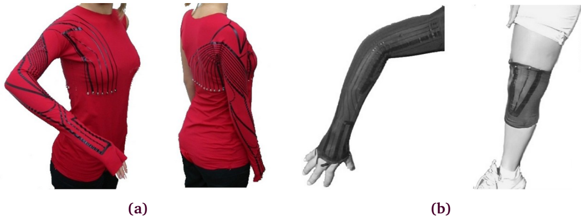
Figure B.2 – Capteurs conçu avec un procédé de revêtement : (a) capteur de flexion à base d'élastomère chargé en carbone (Tognetti et al., 2005) et (b) capteur de flexion à base de fils élastiques enduits de PPy (Lorussi et al., 2004)
