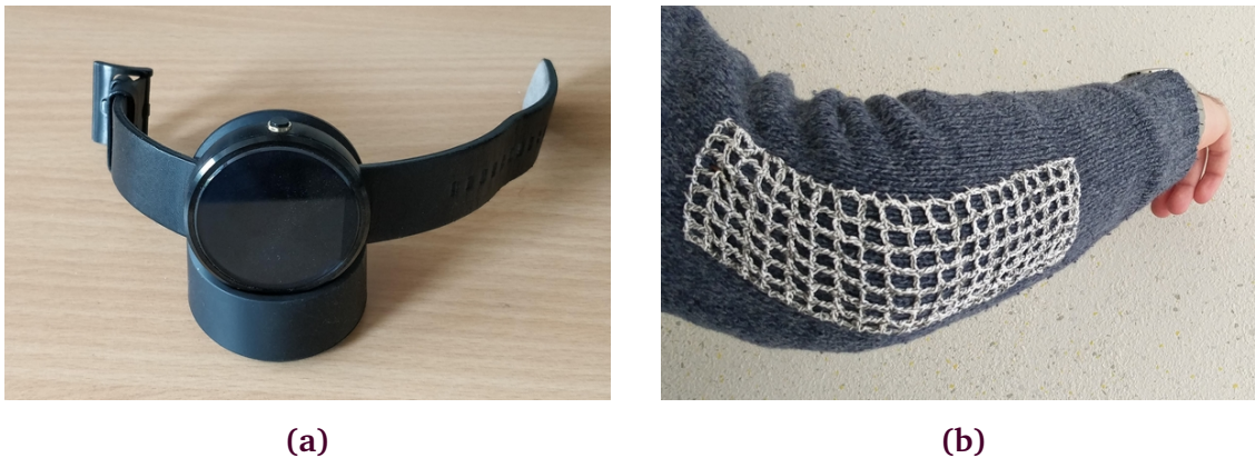
Figure 3.6 – Objets de suivi des fonctions motrices du bras : (a) le bracelet et (b) le vêtement instrumenté
