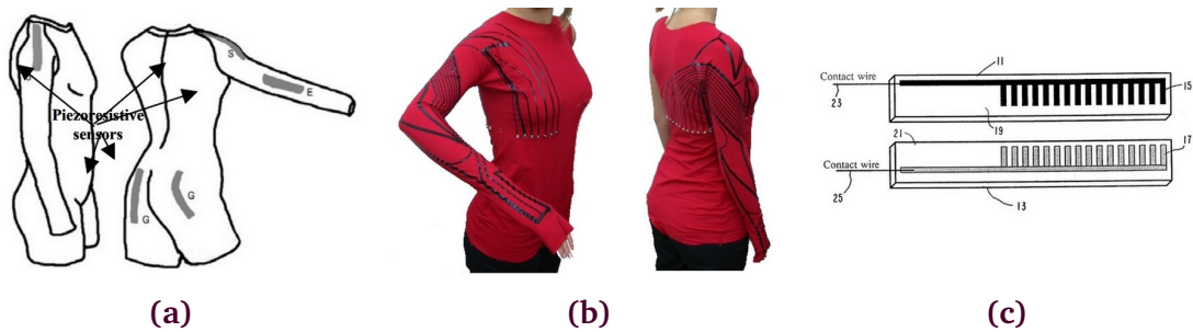
Figure 2.24 – Capteurs de flexion : (a) tricotés (Taccini et al., 2004), (b) conçu avec un procédé de revêtement à base d'élastomère chargé en carbone (Tognetti et al., 2005) et (c) capacitif en superposant plusieurs couches (Neely and Restle, 1997)
