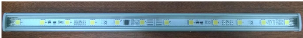
Figure 66 : Exemple de réglatte à LEDs pour application domotique avec les résistances d'équilibrage
