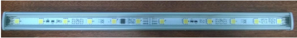
Figure 66 : Exemple de réglotte à LEDs pour application domotique avec les résistances d'équilibrage
