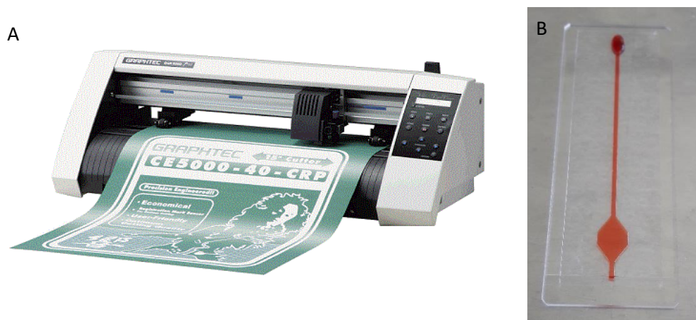
Figure 20 : (A) appareil de xurographie (GRAPHTEC CE 5000 – source : http://www.promattex.com ). (B) puce microfluidique à canal unique réalisée par xurographie (photographie personnelle).
