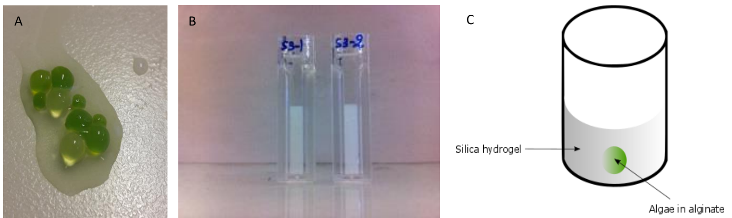
Figure 19 : Illustration du principe d'immobilisation des microalgues via l'utilisation d'hydrogels. (A) Billes d'alginate contenant des microalgues immobilisées, (B) Hydrogel de silice, (C) Principe de double encapsulation des algues dans des micropuits.
