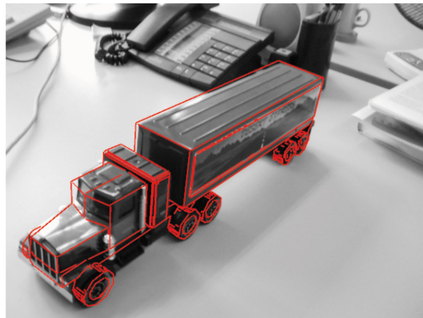
FIGURE 2.4 – Reconnaissance et suivi d'objets basés sur un modèle 3D. Nous pouvons observer le modèle 3D en fil de fer incrusté dans l'image. Crédit : WUEST et collab. [2007].
