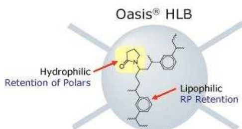
Figure 49 : Représentation du copolymère de divinylbenzène et de N-vinylpyrrolidone constituant la phase Oasis HLB des POCIS et des cartouches d'extraction sur phase solide (SPE) ( www.waters.com )
