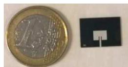
Figure 3.61 : Photographie d'une antenne patch avec une adaptation par fentes.
