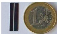
Figure 2.38 : Photographie de la ligne microruban dopée.
