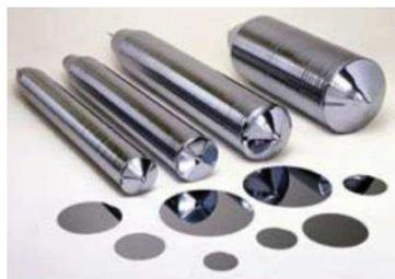
Figure 1.40 : Cylindres et wafers de silicium [117].
