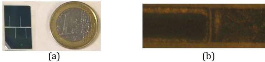
Figure 3.26 : (a) Photographie du filtre accordable sans saut d'impédance. (b). Photographie au microscope de la transition zone non dopée / zone dopée d'un résonateur coupé.
