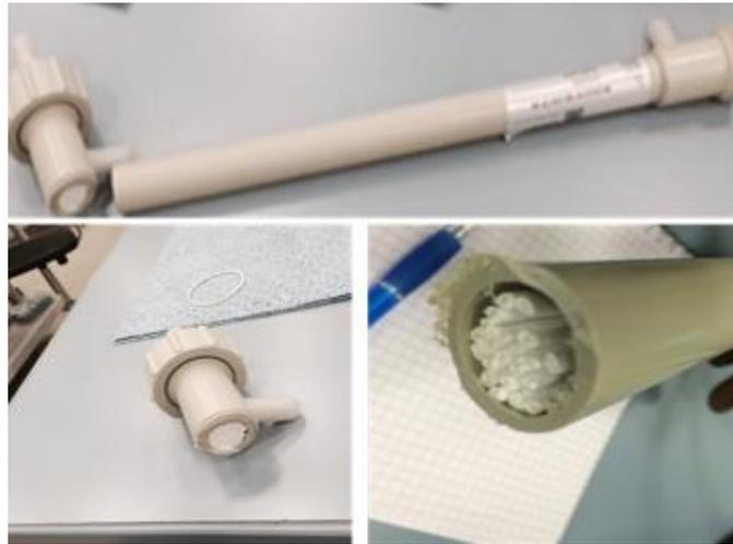
**Figure V.3** : Image du module MICRODYN® (référence : MD 020 CP 2N) fournie en France par Alting.
