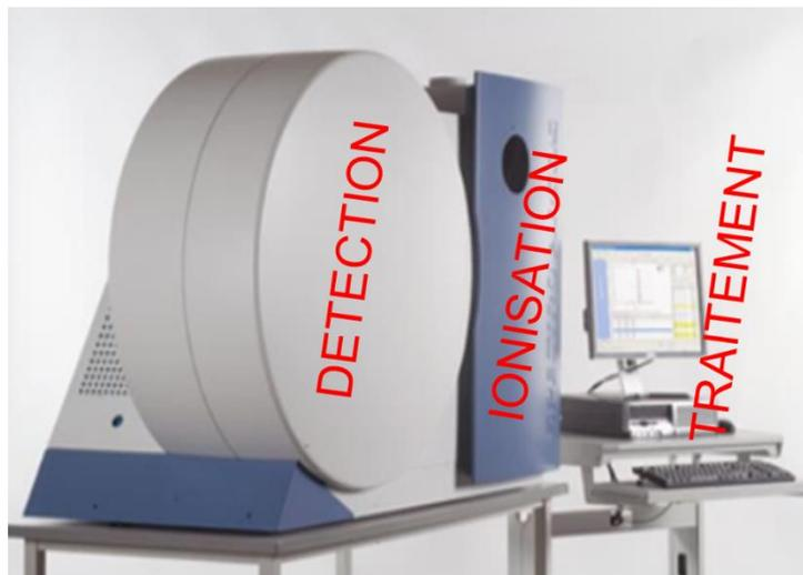
**Figure B** : Spectromètre ICP SPECTRO ARCOS.
