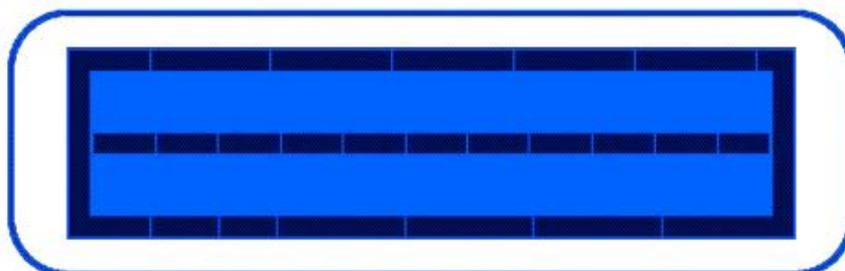
Figure III. 19 : Niveau métallisation dans le cas d'un émetteur type 1 à deux bandes
