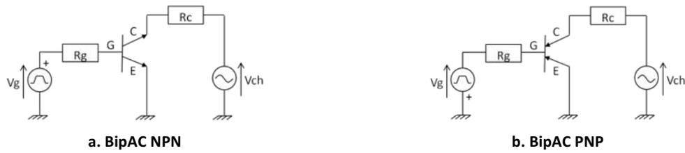
Figure II. 49 : Circuits simulés pour l'étude en commutation pour le BipAC NPN et PNP respectivement
