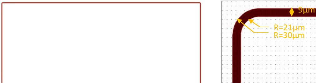
Figure III. 2 : Niveau de masque pour tranchée profonde continue
