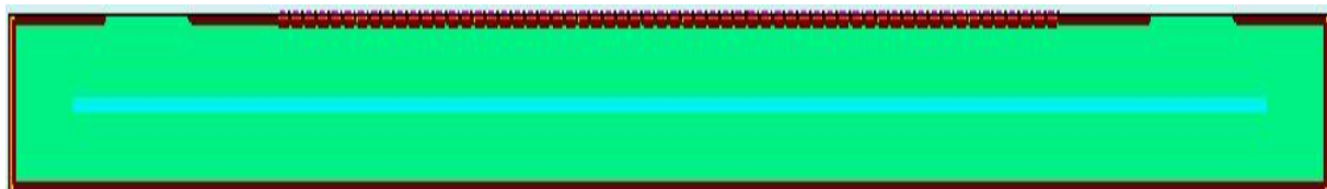
Figure II. 95 : Puce complète du BipAC NPN avec la couche P enterrées dans le substrat P - et la périphérie
