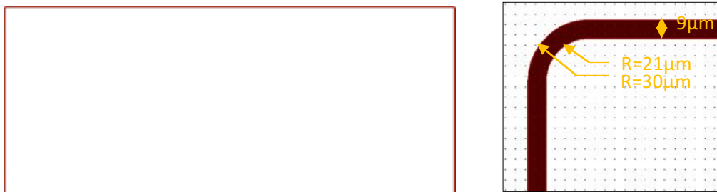
Figure III. 2 : Niveau de masque pour tranchée profonde continue
