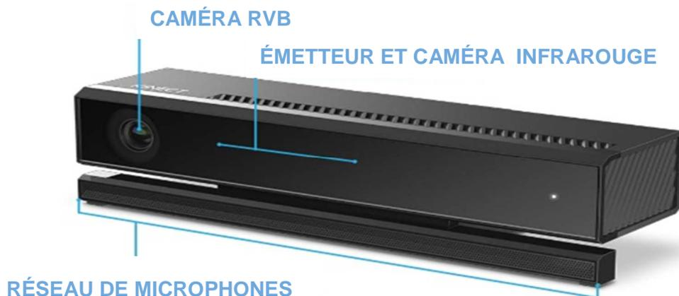
Figure 13 - Le capteur Kinect v2.0
