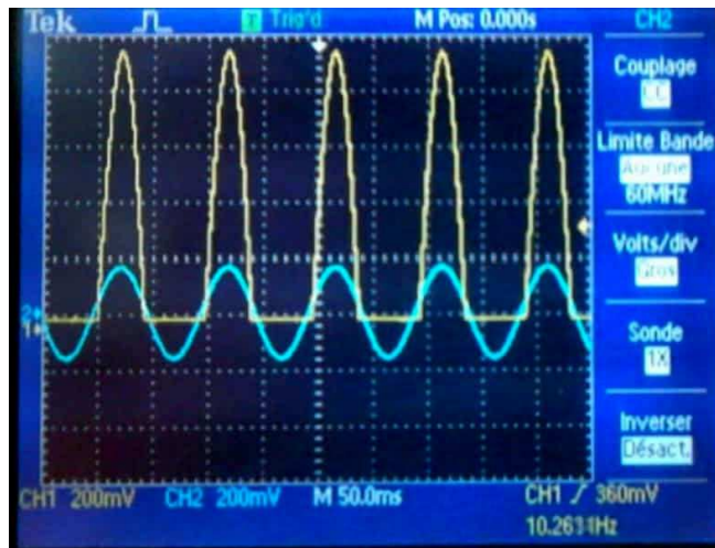
Figure 31 - Signal d'entrée sinusoïdal et signal de sortie amplifié et fauché
