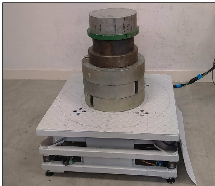
Figure 38 - Masses combinées, utilisées pour l'étalonnage de la plateforme de force
