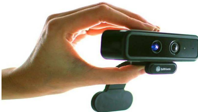
Figure 16 - Le système de capteur DepthSense 311, développé par Soft-Kinetic
