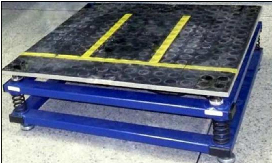
Figure 1 - Plateforme de force développée au Brésil
