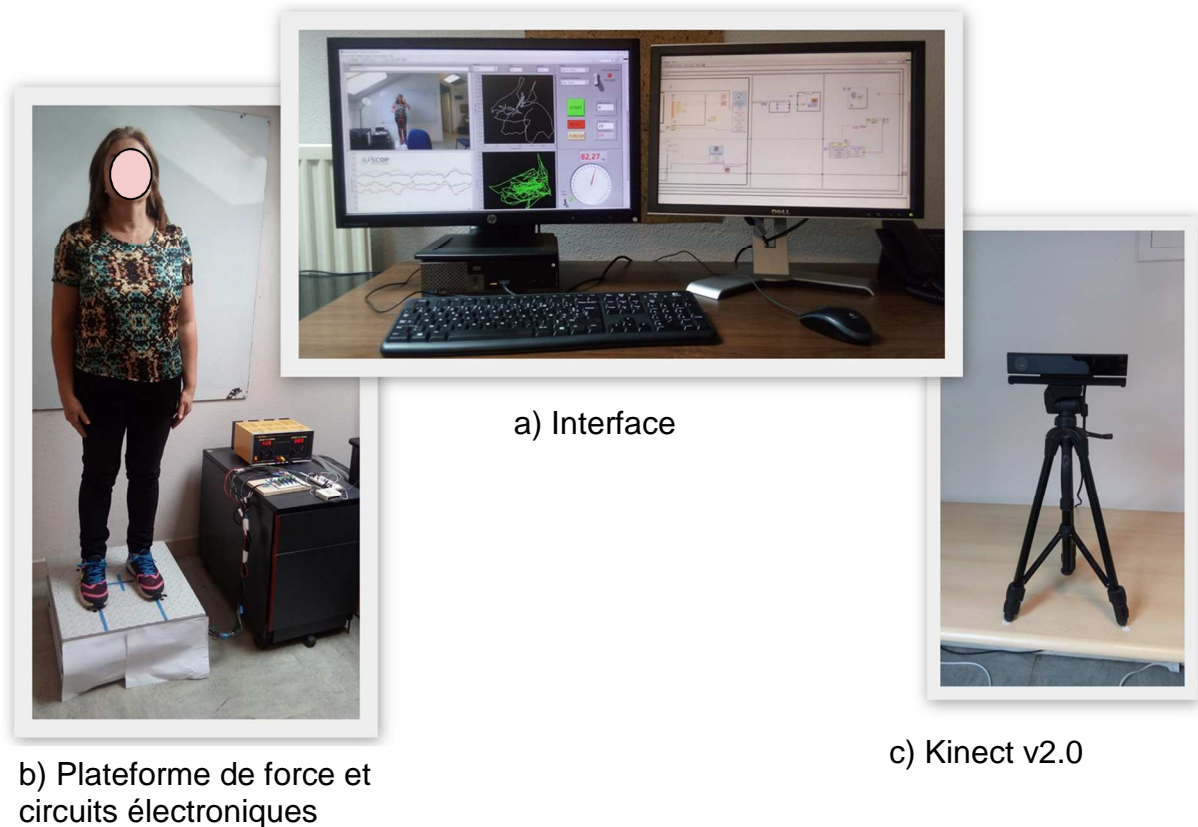
Figure 56 - Environnement expérimental de l'analyse de l'équilibre postural
