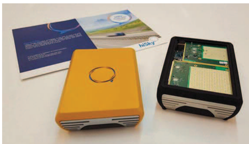
Figure I-16 : Terminal de communication par satellite développé par HiSkySat [32]
