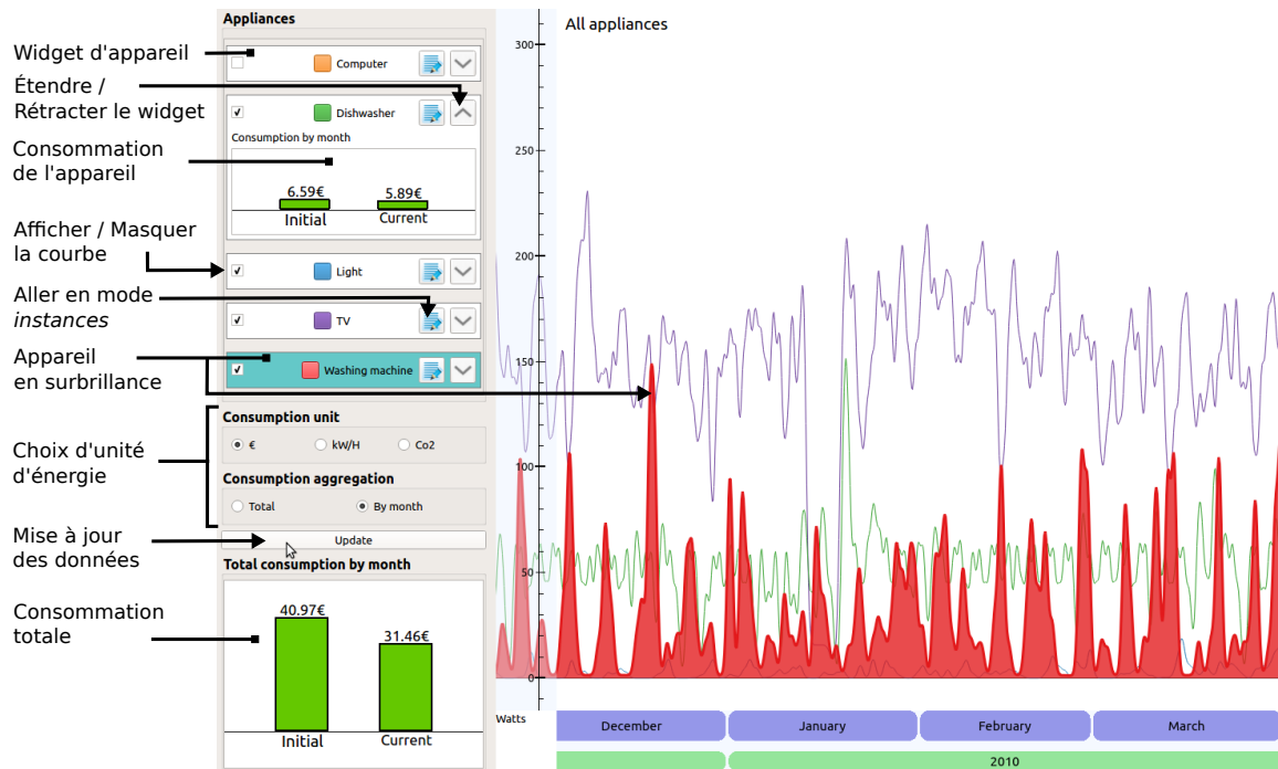
Figure 4.4 – Interface du mode appareils. Cinq appareils sont affichés : un ordinateur (orange), un lave-vaisselle (vert), une lumière (bleu), une télévision (violet) et un lave-linge (rouge). Le lave-linge a été mis en surbrillance par l'utilisateur, la courbe de l'ordinateur a été cachée et le widget du lave-vaisselle a été étendu pour visualiser sa consommation. En bas à gauche de l'interface un graphique en bâtons permet de visualiser la consommation totale initiale (sans modifications) ainsi que la consommation totale actuelle (avec modifications appliquées).
