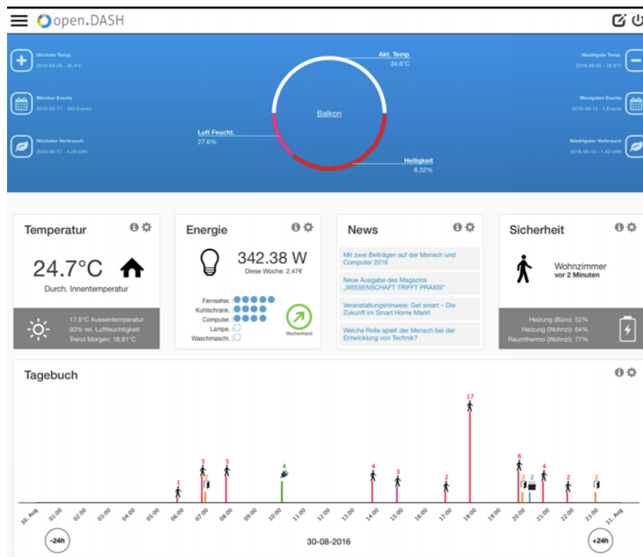
Figure 3.5 – Capture d’écran du dashboard open.DASH, permettant de visualiser les données d’une maison connectée. Ce système permet aux utilisateurs de créer leurs propres visualisations à partir des flux de données de la maison. Ici une visualisation d’événements au cours du temps a été créée par l’utilisateur, comprenant par exemple les ouvertures de porte.
