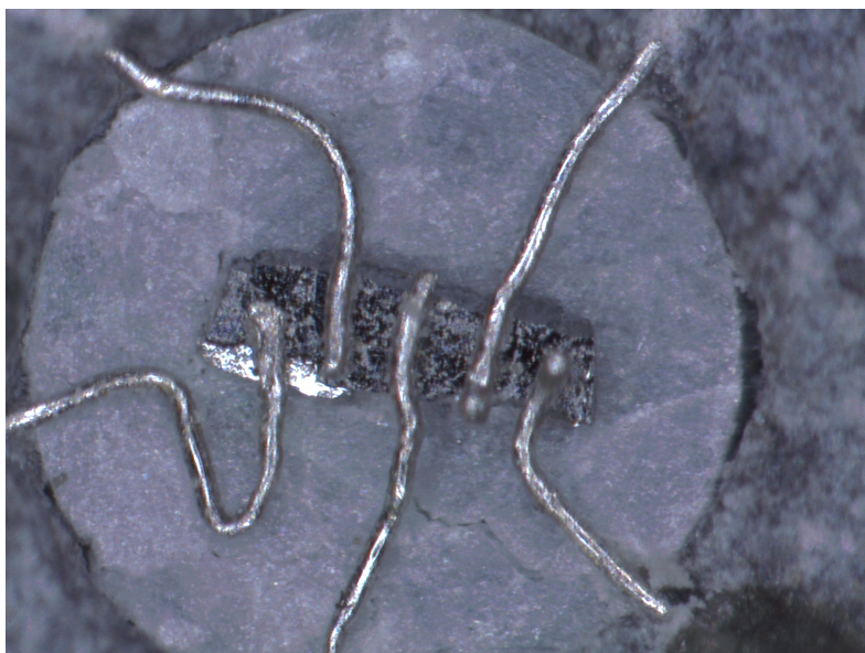
FIGURE 0.0.22 – Monocrystal de CrSb_2 contacté par 5 fils de platine
