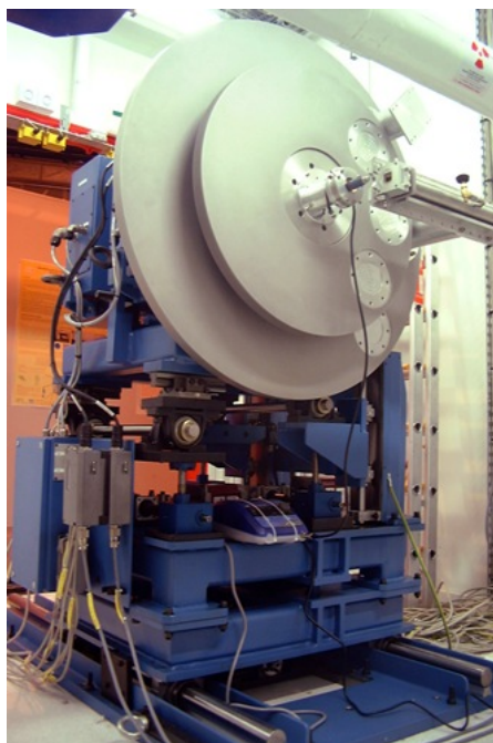
FIGURE 0.0.26 – Détecteur \theta - 2\theta de DRX à haute résolution de la ligne BM25 (ESRF, Grenoble)[20]
