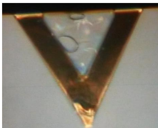
Figure III-12. Photo de la pointe d'AFM utilisée pour imager les microgels de PNL-N2.6 réticulés après avoir baissé le pH à 4 – un film de polymère est clairement visible au centre du cantilever.
