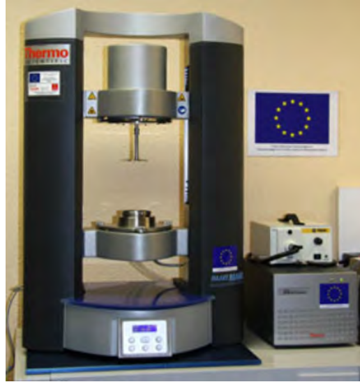
Figure 3.3 – Le rhéomètre Haake Mars III et son module de microscopie associé RheoScope (ThermoFisher Scientific).
