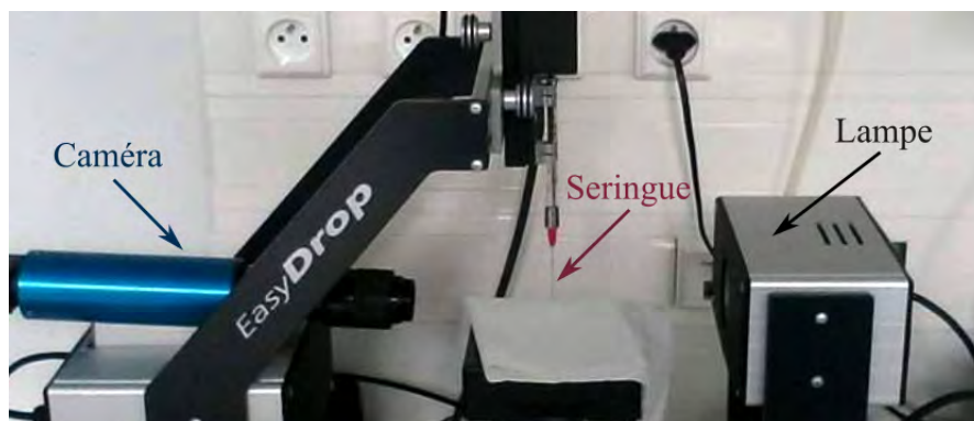
Figure 3.1 – Tensiomètre Drop Shape Analyzer-DSA100 (Krüss). Une seringue micrométrique permet de former une goutte de liquide suspendue. Le profil de la goutte est obtenu à l'aide d'une caméra CCD.
