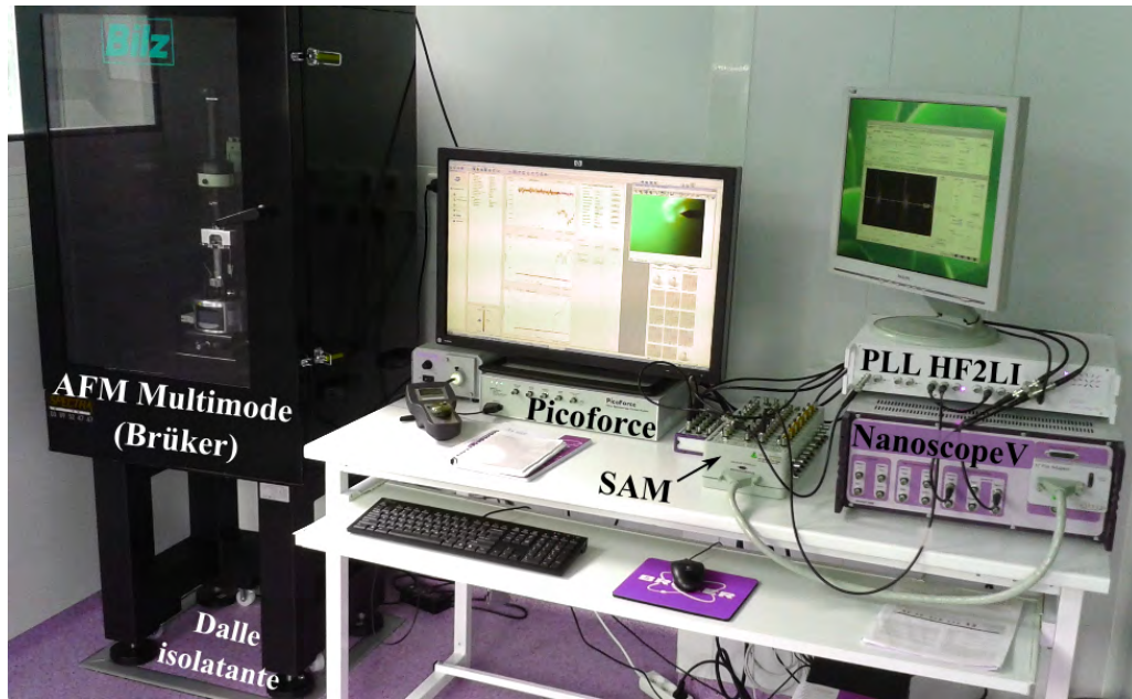
Figure 6.10 – Photographie du dispositif expérimental. L’AFM Multimode (Bruker) équipé du module PicoForce est piloté par le contrôleur Nanoscope V. Le mode FM est assuré par le module PLL-HF2LI (Zürich Instrument) connecté à l’AFM au niveau du module d’accès aux signaux (SAM). L’ensemble du dispositif est situé dans une salle blanche.
