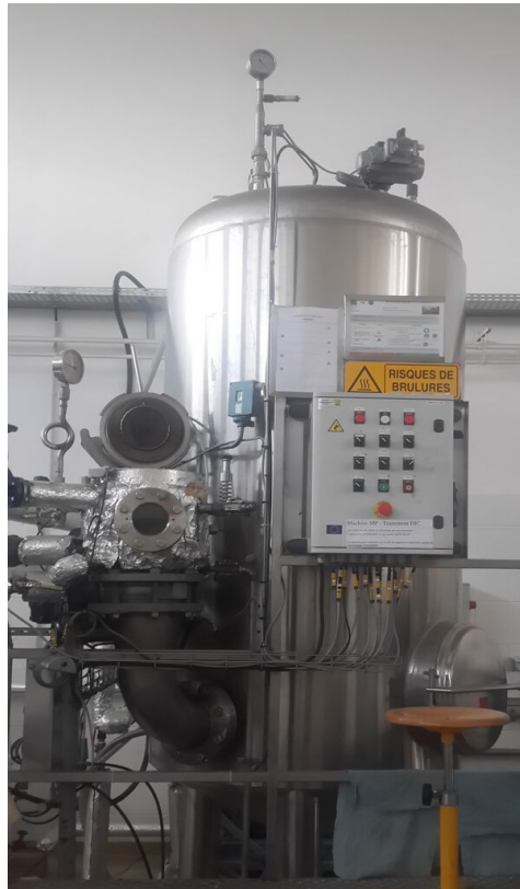
Figure 3. Schéma d'un réacteur DIC de taille laboratoire : (1) chambre de traitement avec double enveloppe ; (2) vanne de détente abrupte ; (3) réservoir à vide ; (4) pompe à vide ; (5) chaudière
