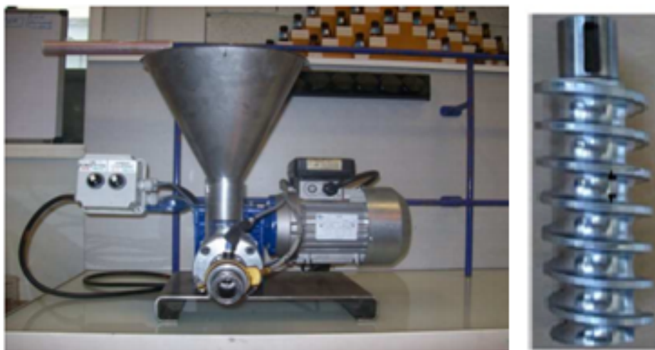
Figure 14. Configuration de presse à mono-vis
