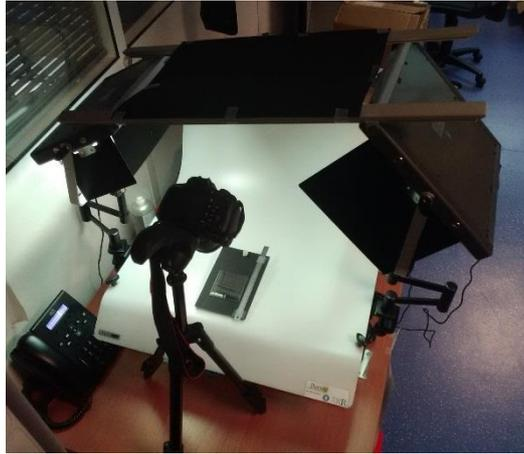
Figure III-1 : Banc de photographie des miroirs
