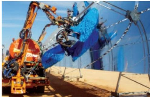
Figure II-13 : Nettoyage de miroirs cylindro-paraboliques avec un camion adapté à Ain Beni Mathar au Maroc. <sup>[1]</sup>
