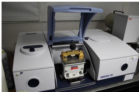
Figure III-5 : Spectromètre Bruker Vertex 70 équipé de l'accessoire ATR.
