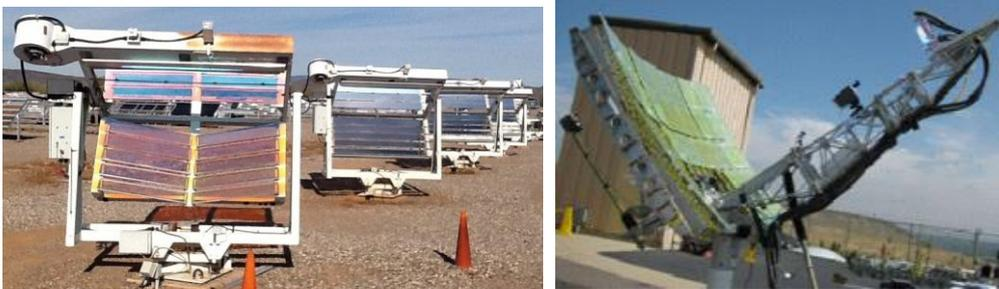
Figure II-6 : Le système Ultra-Accelerated EMMA <sup>[99]</sup> à gauche et l'UAWS <sup>[65]</sup> à droite.
