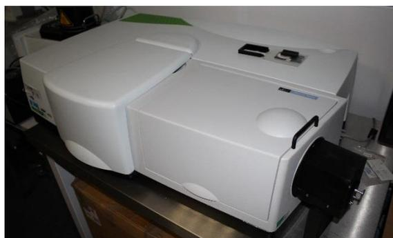
Figure III-4 : Spectrophotomètre Perkin-Elmer Lambda 950 avec sphère d'intégration.
